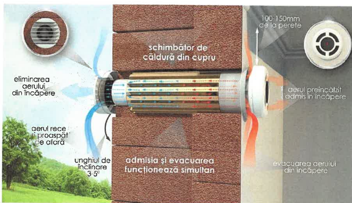
Figura 6 Soluție sistem de ventilație descentralizat
